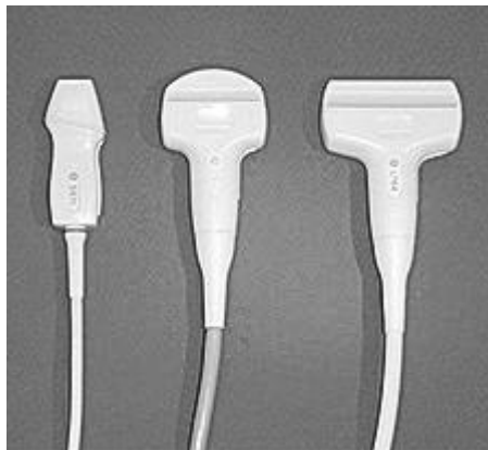
Sa leva na desno: sektorska, konveksna i linearna sonda. From left to right: sector, convex, and linear probes.
